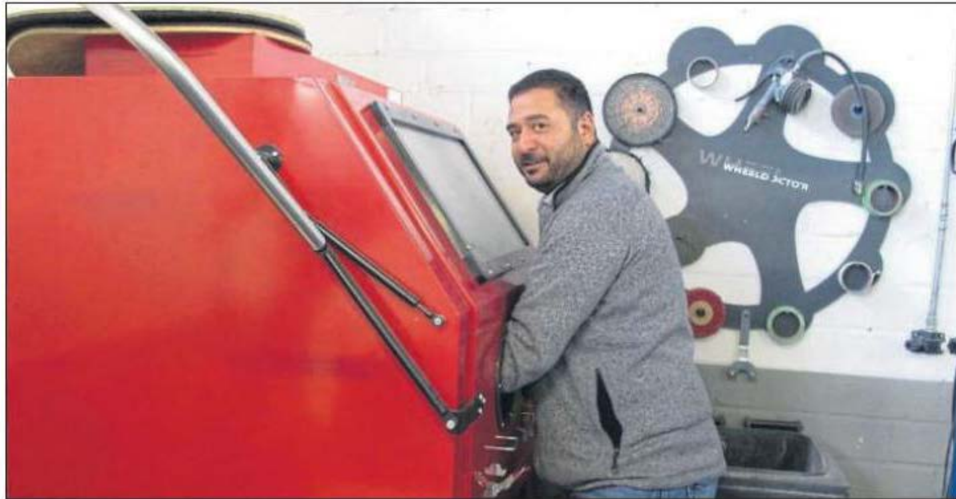
Berkant Albayrak strahlt in einer Maschine Felgen ab und lackiert sie anschließend neu. • Foto: scho
